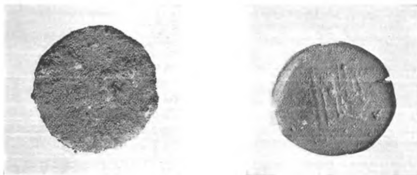
Fig. 1: Moneta etrusca in bronzo, prima e dopo il trattamento elettrolitico, secondo il metodo Fink - Ingr. X 1 (lastra n. 15653 e n. 15675).
