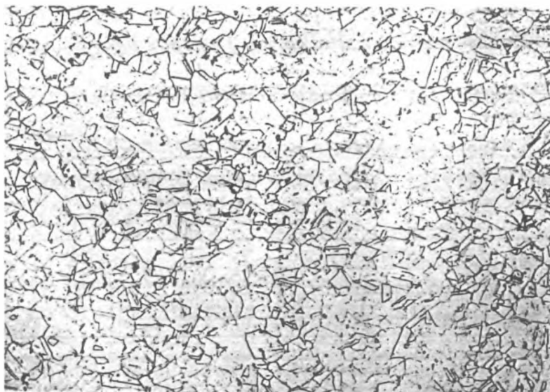
Fig. 3: Microstruttura del chiodo in esame rilevata nell'interno del gambo. Attacco: \text{FeCl}_3 + \text{HCl} - Ingr. X 100.
