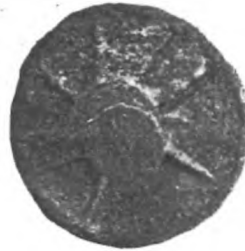
Fig. 2: Aspetto della superficie inferiore della testa del chiodo esaminato. Si osservano le tracce stellari lasciate dalla forma su cui è stata ribattuta la testa - Ingr. X 2,5.
