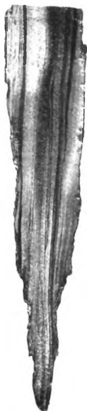
Fig. 1. - Ascia etrusca in ferro, del VII-VI sec. a. C., da Vetulonia - Ingr. x 1. Fig. 2. - Macrostruttura di un particolare della sezione del tagliente dell'ascia. Ingr. x 5 - attacco: Nital 1 o / 0 . Fig. 3. - Schema della sezione di fig. 2 con indicate le durezza Vickers e le strutture tipiche delle varie zone della sezione (v. tav. XXXVI).
